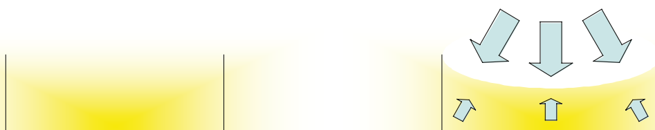
Figura 7a. Deformación durante la polimerización de composites fluidos y de bajo módulo. El stress de contracción se da en la superficie; por consiguiente se da menos stress en las paredes de la cavidad.
