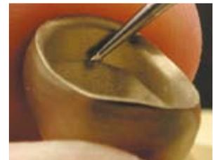
16. Colocar los bebederos, según el sistema de colado y método usado.
