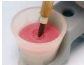
4. La gota de resina se mantiene estable en la punta del pincel y está lista, por ejemplo, para modelar el modelo secundario de la corona.
