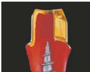
2. Coping electroformado AGC® después de una deposición de oro.
