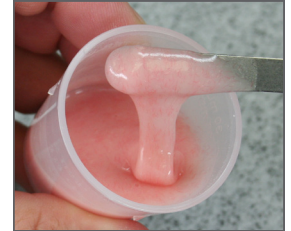
10. Evitar la incorporación de burbujas de aire dentro de la mezcla
